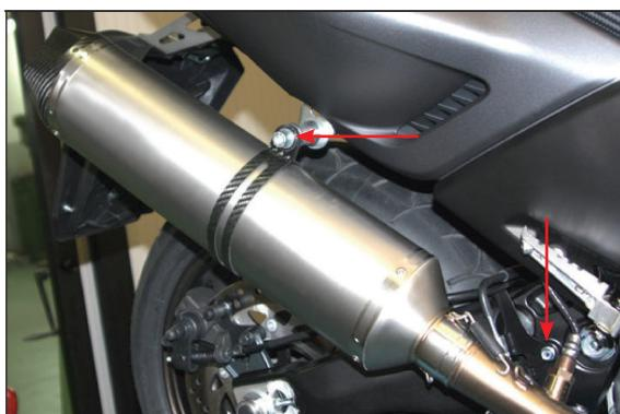
Inserire il terminale nel raccordo e fissarlo con la apposita fascetta e la bulloneria Malossi fornita nel kit, avvitare la sonda lambda, ricollegare il cavo della sonda e quindi rimontare la carenatura laterale. Fissare il silenziatore al raccordo utilizzando la molla.
