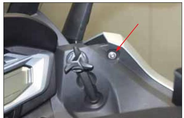
**Solo in caso di montaggio del kit collettori:** rimuovere la vite indicata.
