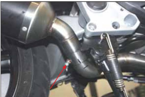
Innestare il silenziatore sul raccordo originale o sul raccordo Malossi (**Solo in caso di montaggio del kit collettori**) come mostrato in foto. Montare sui bussolotti le viti M6 fornita nel kit di montaggio (vedi foto).
