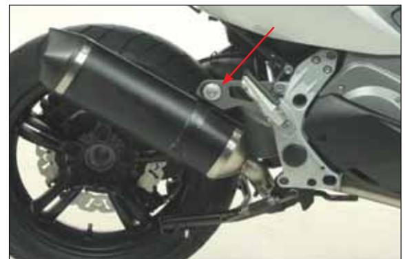
Fissare il silenziatore alla staffa di supporto, come mostrato in foto, utilizzando la fascetta e la bulloneria fornita nel kit di montaggio e lo spessore originale.
