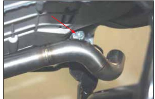
**Solo in caso di montaggio del kit collettori:** fissare il raccordo 2:1 allo spessore filettato con la bulloneria fornita nel kit di montaggio.
