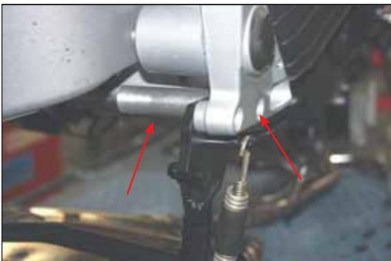
**Solo in caso di montaggio del kit collettori:** fissare lo spessore filettato da entrambi i lati come mostrato sopra.
