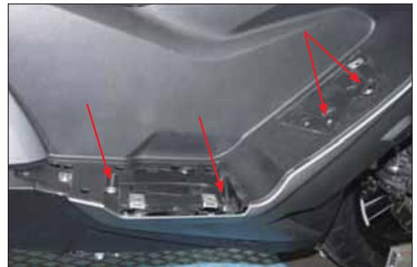
**Solo in caso di montaggio del kit collettori:** rimuovere le viti indicate.
