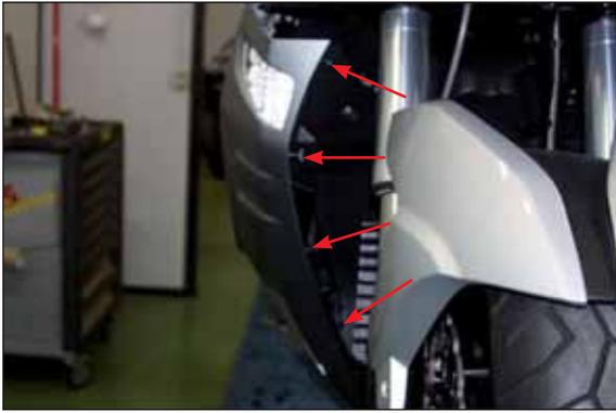
**Solo in caso di montaggio del kit collettori:** rimuovere i perni in plastica neri all'interno della carena DX.
