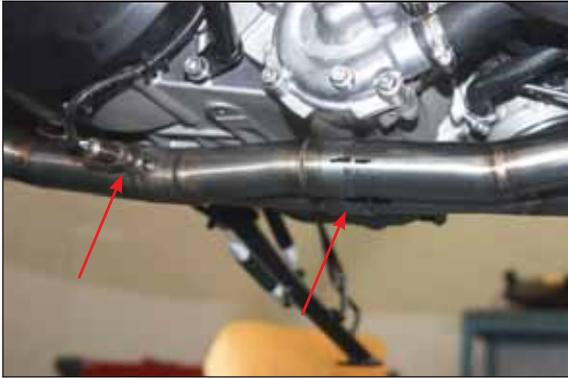
**Solo in caso di montaggio del kit collettori:** montare il raccordo 2:1 sui cilindri, fissare le molle tra collettori e raccordo e innestare la sonda lambda.
