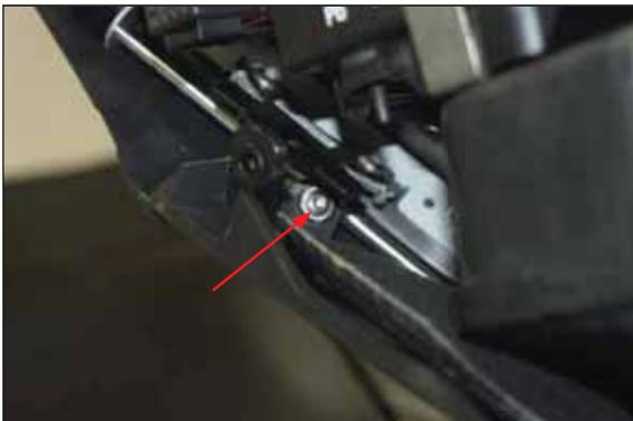
**Solo in caso di montaggio del kit collettori:** scostare la plastica della carena DX e rimuovere la vite indicata vicino alla batteria.
