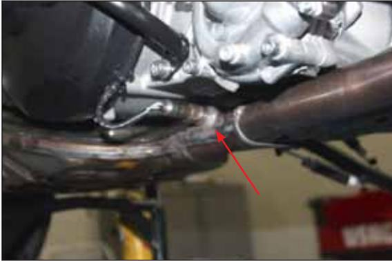
**Solo in caso di montaggio del kit collettori:** svitare la sonda lambda.
