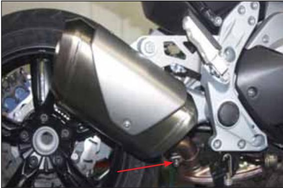
Rimuovere la vite che fissa il terminale originale alla staffa di supporto ed allentare la fascetta stringitubo. Smontare il silenziatore originale.
