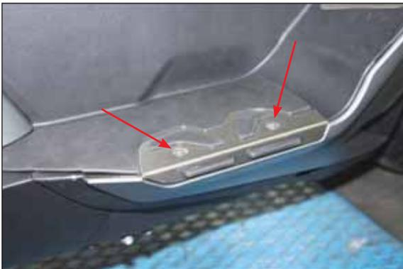
**Solo in caso di montaggio del kit collettori:** rimuovere le viti indicate.
