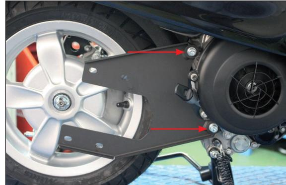
Avvitare al motore la staffa di sostegno terminale
