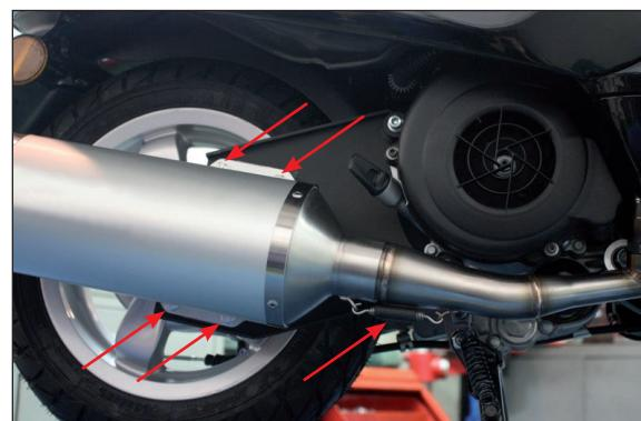
Innestare il terminale, serrare gli attacchi al telaio ed ancorare la
