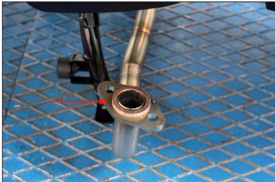
Alloggiare la guarnizione originale nel collettore
