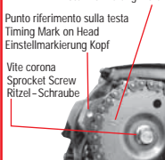
Fig. 2 Riferimento sulla corona Timing Mark on Sproket Einstellmarkierung Ritzel
