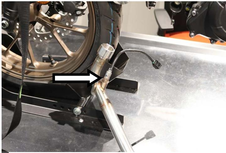
**IT** · Avvitare la sonda lambda nel collettore Arrow
