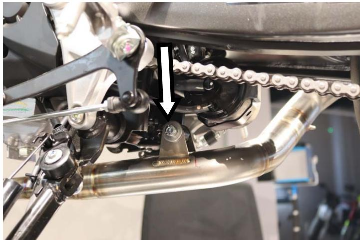
**IT** · Serrare senza stringere completamente l'attacco del collettore al telaio
