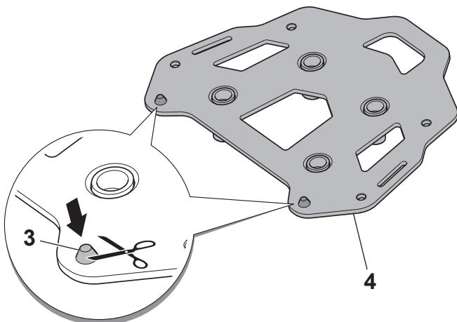
**F** Assembler les deux plots en caoutchouc **3** sur la plaque de support **4**, comme le montre le dessin.
