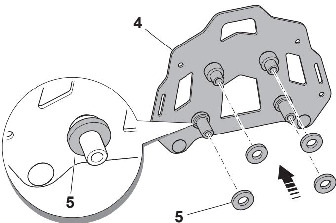
**D** Die zwei Auflagegummis **3** gemäß Zeichnung auf der Halteplatte **4** montieren.
