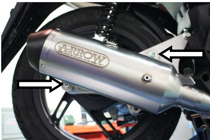
Innestare il terminale e serrare gli attacchi (2) alla piastra del forcellone Fit Arrow silencer and secure it to the swingarm
