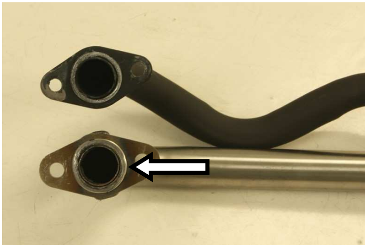
Alloggiare la guarnizione originale nel collettore Fit OE gasket to Arrow collector, as shown above
