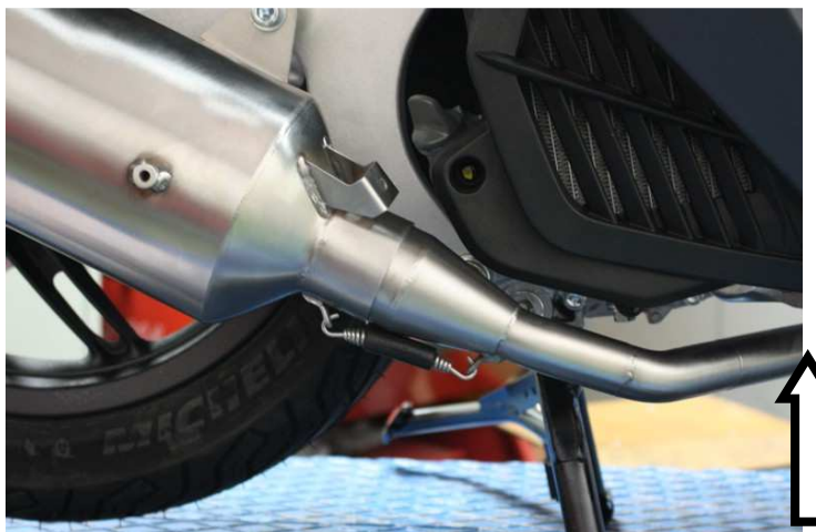
Ancorare la molla e serrare definitivamente il collettore al cilindro Fit the spring and tighten the bolts securing the collector to the cylinder
