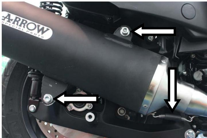
**IT** · Innestare il terminale, serrare gli attacchi al telaio ed ancorare la molla
