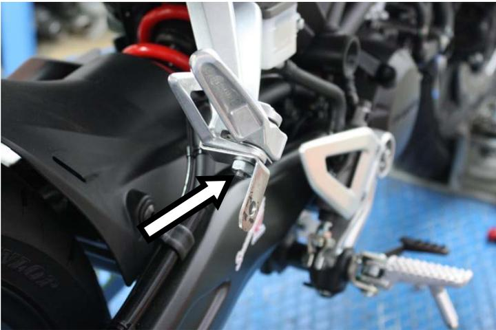
**IT** · Fissare la staffa di sostegno terminale al perno
