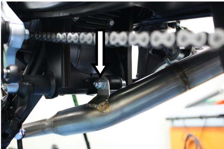
**IT** · Serrare senza stringere completamente l'attacco del raccordo al telaio
