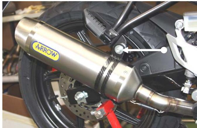
Inserire il terminale Arrow nel raccordo e fissarlo con la fascetta e la bulloneria fornita nel kit.
