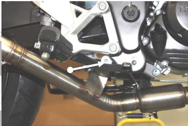
Montare il raccordo terminale nel catalizzatore e fissarlo al telaio nello stesso punto dell'originale con la bulloneria fornita nel kit.
