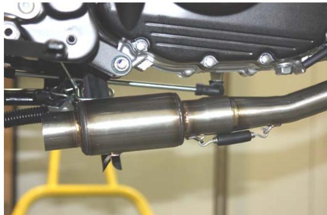
Innestare il raccordo Arrow nel collettore e fissarlo con le apposite molle.
